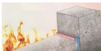
I Junta combinada com silicone FP 402 e espuma FP 404
